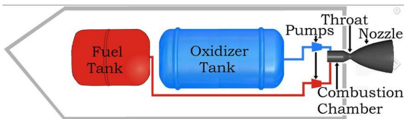
ภาพที่ 28 แสดงส่วนประกอบของเชื้อเพลิงเหลว
