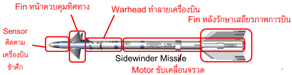
ภาพที่ 15 แสดงส่วนประกอบของจรวดต่อสู้อากาศยาน
