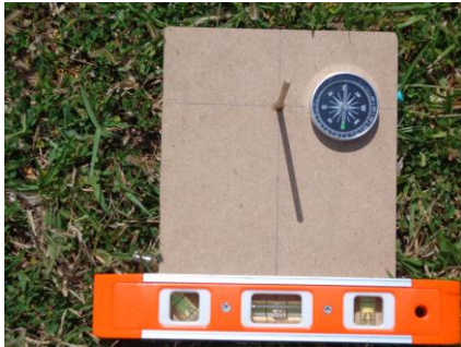
ภาพที่ 1 การทดสอบใช้งานอุปกรณ์วัดพิกัดภูมิศาสตร์ที่สร้างขึ้น
